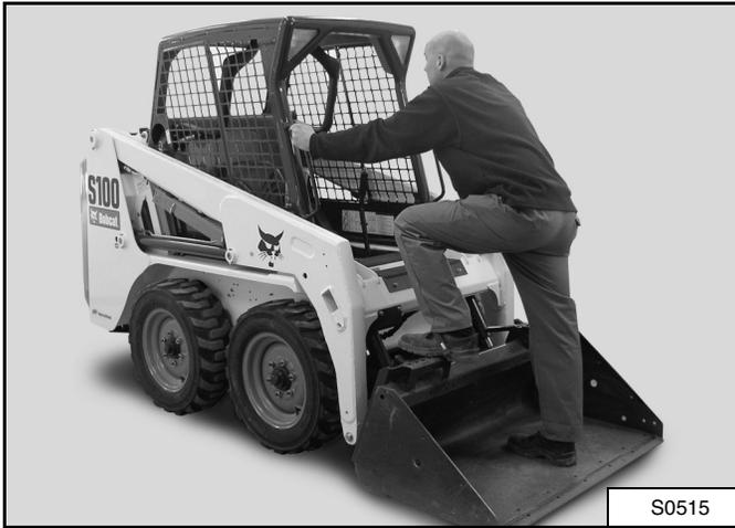
Use los escalas del cucharón o aditamento, las palancas de agarre y los peldaños de seguridad (en el brazo y el bastidor del cargador) para ingresar y salir del cargador, manteniendo 3 puntos de contacto todo el tiempo [Figura 75]. NO SALTE.
