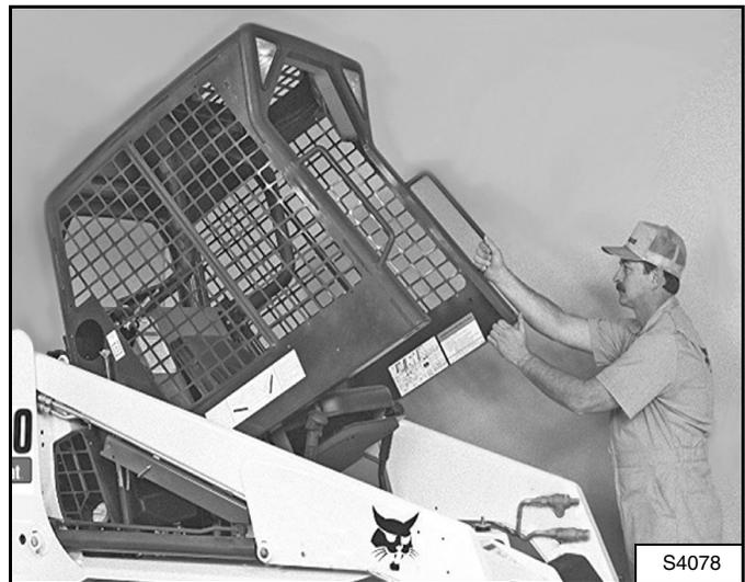
Suba las palancas de agarre y el extremo inferior de la cabina del operador lentamente hasta que la cabina quede completamente arriba y el mecanismo de seguridad se enganche [Figura 138].
