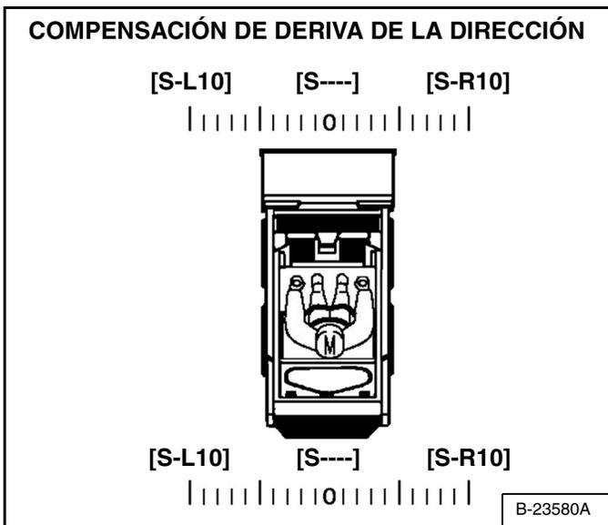
La compensación de deriva de la dirección contiene 21 ajustes. Este sistema se puede ajustar en cualquier punto entre la posición NEUTRAL y [S-L10] izquierda y entre la posición NEUTRAL y [S-R10] derecha. El texto [S----] aparece en la pantalla cuando se configura para la posición NEUTRAL [Figura 49].
