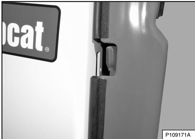
Alcance la ranura al interior de la compuerta trasera y tire del cerrojo [Figura 144].
