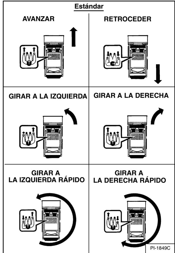
Las palancas de dirección controlan el avance, el retroceso y el giro del cargador [Figura 34].
