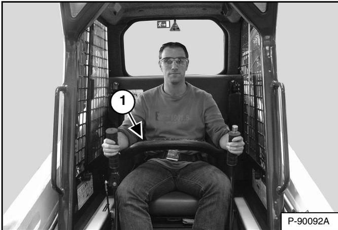
El Sistema de Enclavamiento de Controles Bobcat (BICS<sup>MR</sup>) tiene una barra del asiento que hace pivote con descansa brazos (ítem 1) [Figura 21]. El operador controla el uso de la barra del asiento.
