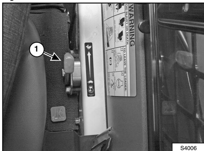
Coloque la palanca de control (ítem 1) [Figura 93] a la velocidad en vacío.
