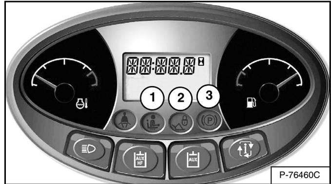
Hay tres lámparas (ítem 1, 2 y 3) [Figura 22] ubicadas en el panel de instrumentos izquierdo que deben estar APAGADAS para operar la máquina plenamente.
