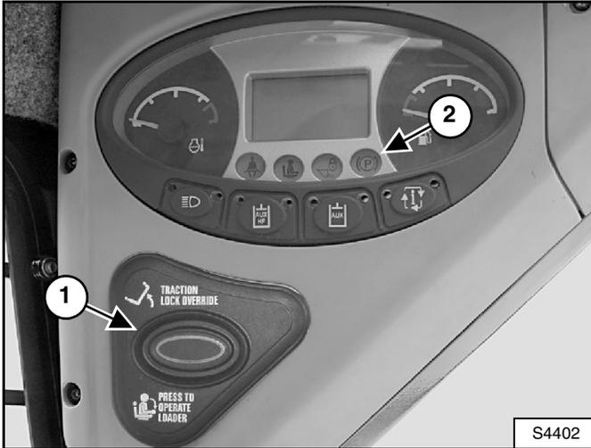
(Solo funciona cuando la barra del asiento se sube y el motor está en marcha). Hay un botón ANULADOR DEL BLOQUEO DE LA TRACCIÓN (ítem 1) [Figura 25] en el panel de instrumentos izquierdo que permite usar las palancas de dirección para mover el cargador hacia adelante o atrás cuando se usa la retroexcavadora.
