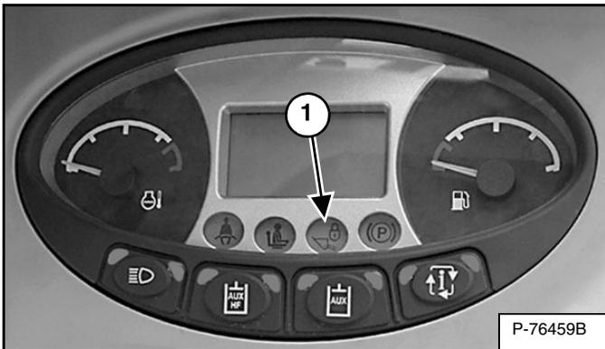
La luz de las VÁLVULAS DE ELEVACIÓN E INCLINACIÓN (ítem 1) [Figura 142] se APAGA cuando la puerta se cierra, el interruptor de llave se gira a RUN o el botón RUN / ENTER se oprime, la barra del asiento se baja y el botón PRESS TO OPERATE LOADER se oprime.
