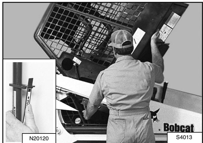
Tire hacia abajo el extremo inferior de la cabina del operador hasta que ésta se detenga en el mecanismo de seguridad [Figura 139].
