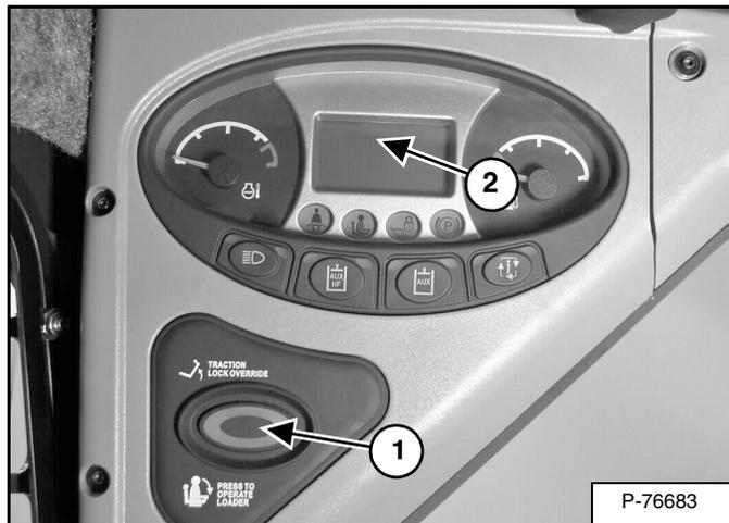
Oprima el botón PRESS TO OPERATE LOADER (ítem 1) [Figura 97] para activar el BICS<sup>MR</sup> y para usar las funciones hidráulicas y del cargador.
