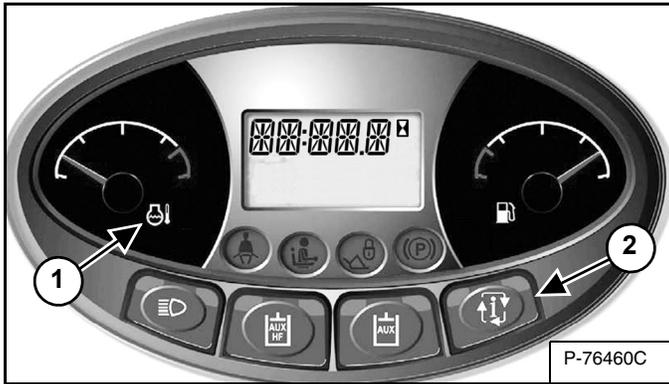
Monitoree frecuentemente los medidores de temperatura y combustible y las lámparas del BICS<sup>MR</sup> (todas las lámparas del BICS<sup>MR</sup> deben estar apagadas para operar el cargador) [Figura 98].
