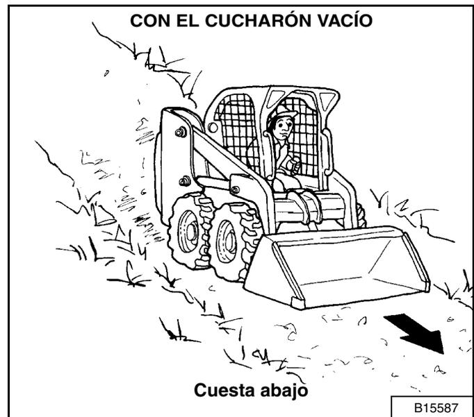
Con un cucharón vacío, suba y baje la pendiente con el espaldar del cargador (extremo pesado) mirando hacia la cima [Figura 118] y [Figura 119].
