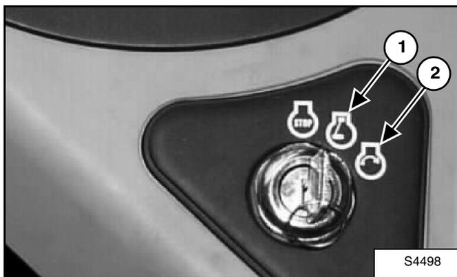
Gire el interruptor a RUN (ítem 1) [Figura 84]. Las luces indicadoras en el panel de instrumentos izquierdo se ENCENDERÁN brevemente y el panel de instrumentos / sistema de monitoreo efectuará una autopruueba.
