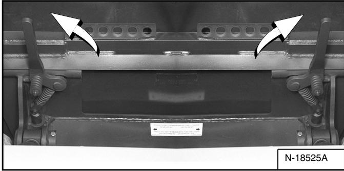
Tire de las palancas del Bob-Tach [Figura 108] completamente hacia arriba.
