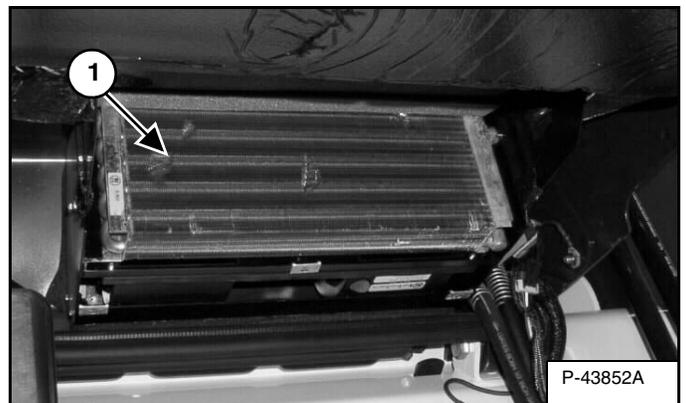
Use aire o agua a baja presión para retirar los escombros de la bobina térmica (ítem 1) [Figura 151].
