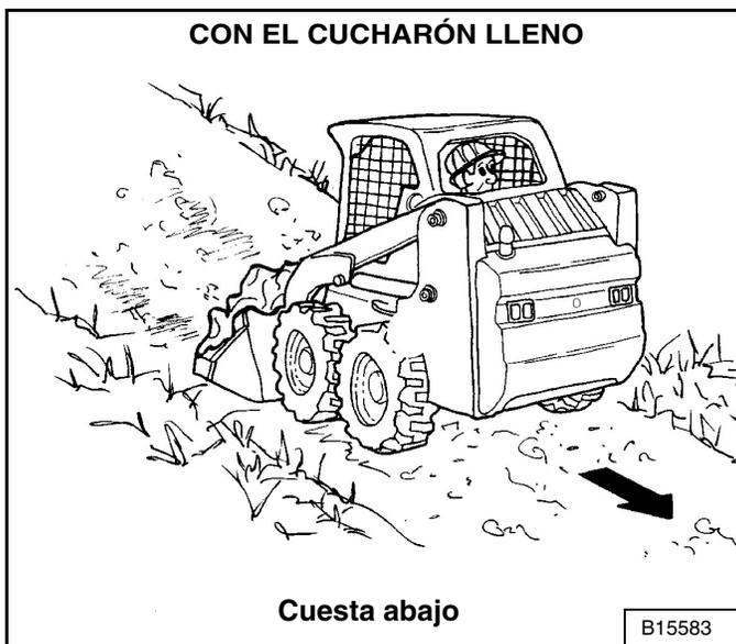
Con un cucharón lleno, suba y baje la pendiente con el cucharón (extremo pesado) mirando hacia la cima [Figura 116] y [Figura 117].
