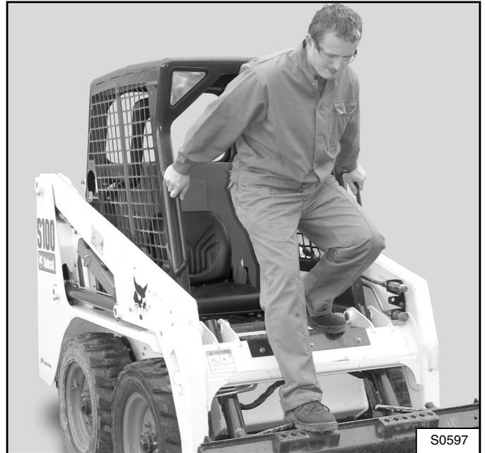
Salga del cargador usando las palancas de agarre, los peldaños de seguridad y los escalas (mantenga un contacto de tres puntos) [Figura 101].
