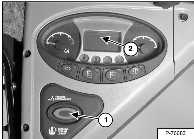
Oprima el botón PRESS TO OPERATE LOADER (ítem 1) [Figura 92] para activar el BICS<sup>MR</sup> y para usar las funciones hidráulicas y del cargador.
