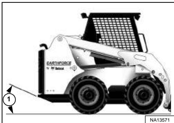
**NOTA:** El cargador se debe elevar lo más cerca del eje horizontal posible, pero el ángulo del cargador suspendido nunca debe exceder el ángulo de desviación (ítem 1) [Figura 66] que aparece en la sección de Especificaciones. (Ver Dimensiones de la máquina en la página 122).
