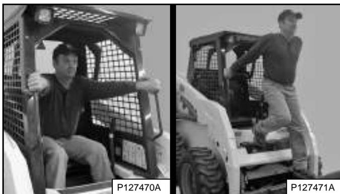
Salga del cargador usando las palancas de agarre, los peldaños de seguridad y los escalas (mantenga un contacto de tres puntos) [Figura 53].
