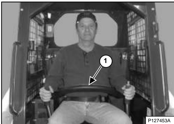
El sistema de restricción del asiento tiene una barra del asiento que hace pivote con descansa brazos (ítem 1) [Figura 73].
