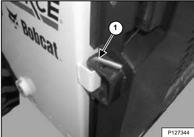
Retire el pasador de seguridad (ítem 1) [Figura 93] y tire de la compuerta trasera para abrirla.
