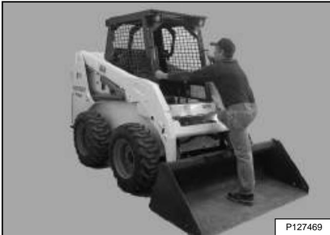
Use las escalas del cucharón o aditamento, las palancas de agarre y los peldaños de seguridad (en el brazo y el bastidor del cargador) para ingresar y salir del cargador, manteniendo 3 puntos de contacto todo el tiempo [Figura 38]. No salte.
