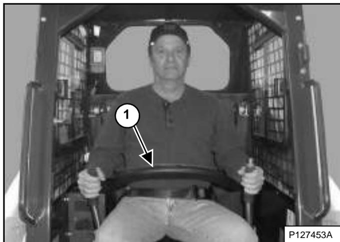
El Sistema de Enclavamiento de Controles tiene una barra del asiento que hace pivote con descansa brazos (ítem 1) [Figura 18]. El operador controla el uso de la barra del asiento.
