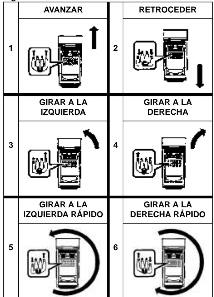
Funciones de la palanca de dirección (manejo y dirección) [Figura 30]:
