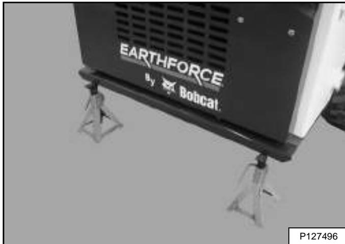
Instale los soportes debajo del extremo posterior del bastidor del cargador [Figura 88].
