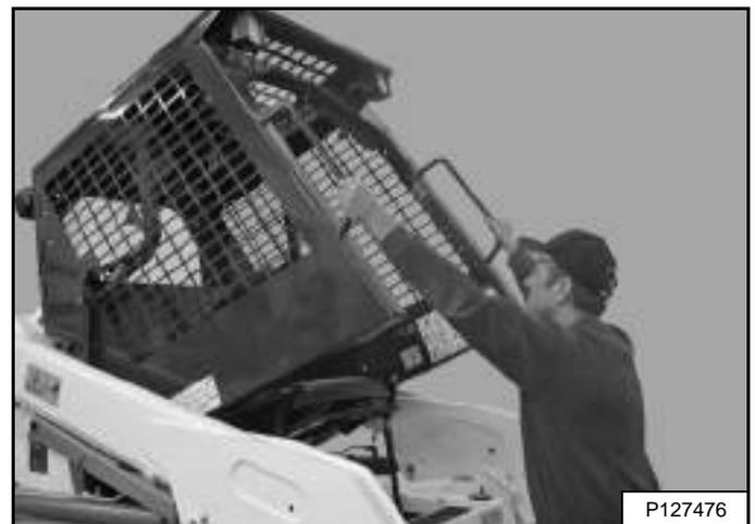
Suba las palancas de agarre y el extremo inferior de la cabina del operador [Figura 90] lentamente hasta que la cabina quede completamente arriba y el mecanismo de seguridad se enganche.
