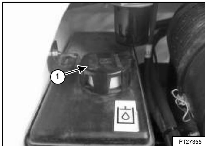
Retire la tapa de desfogue (ítem 1) [Figura 140] y descártela.
