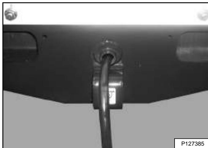
Bombee el fluido retirándolo de la caja de la cadena [Figura 144]. (Los brazos de elevación se muestran levantados para describir el procedimiento con claridad)
