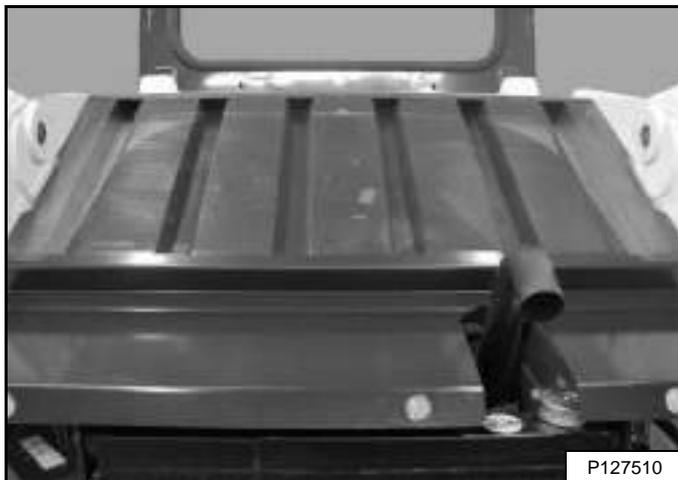
Levante y tire de la rejilla trasera para retirarla del cargador **[Figura 96]**.
