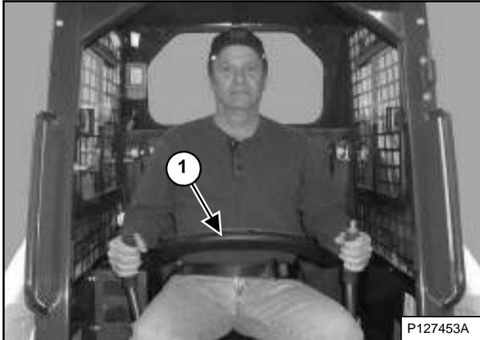
El sistema de restricción del asiento tiene una barra del asiento que hace pivote con descansa brazos (ítem 1) [Figura 20].
