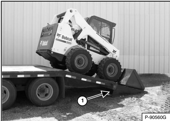
Un cargador con un cucharón vacío o sin aditamento debe cargarse en retroceso sobre el vehículo de transporte [Figura 165].
