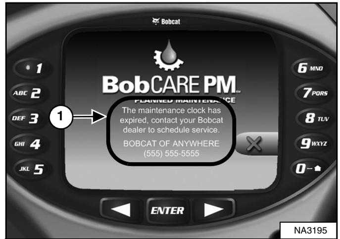
El panel de instrumentos de lujo (si está equipado) muestra un mensaje (ítem 1) [Figura 294] que alerta al operador dar servicio a la máquina.
