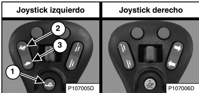
Ajuste un porcentaje de velocidad mayor (ítem 2) o menor (ítem 3) [Figura 71] oprimiendo el interruptor de control de velocidad hasta que aparezca el ajuste por defecto que desea.
