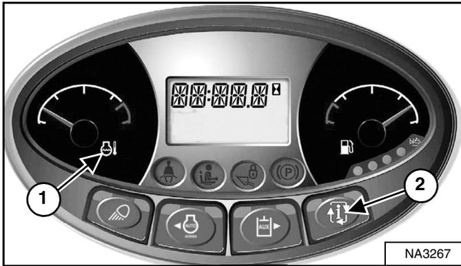
Monitoree frecuentemente los medidores de temperatura y combustible y las lámparas del BICSM<sup>MR</sup> (todas las lámparas del BICSM<sup>MR</sup> deben estar apagadas para operar el cargador) [Figura 137].
