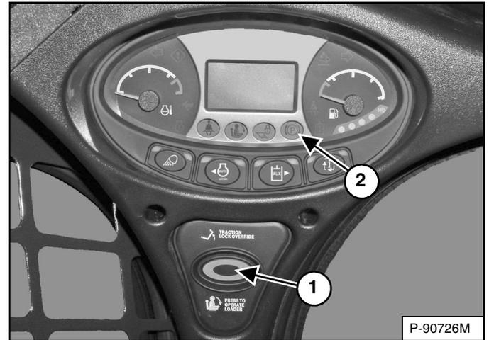
(Solo funciona cuando la barra del asiento se sube y el motor está en marcha) Hay un botón que ANULA EL BLOQUEO DE LA TRACCIÓN (ítem 1) [Figura 39] en el panel de instrumentos izquierdo que permite usar los controles de dirección para mover el cargador hacia adelante y atrás cuando se usa la retroexcavadora.
