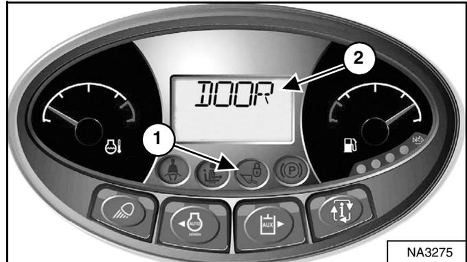
La lámpara de la VÁLVULA DE ELEVACIÓN E INCLINACIÓN (ítem 1) [Figura 182] se APAGA cuando la puerta se cierra, el interruptor de llave se coloca en RUN, la barra del asiento de baja y el botón PRESS TO OPERATE LOADER se oprime.
