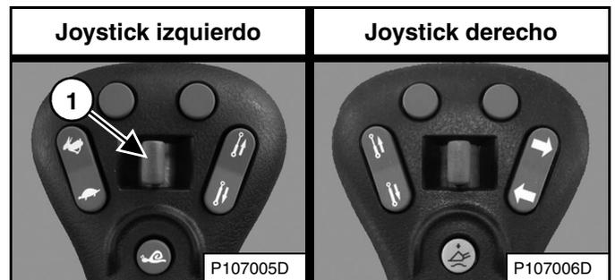
Mueva el interruptor de los hidráulicos auxiliares traseros (ítem 1) [Figura 101] o [Figura 102] hacia la izquierda y derecha varias veces. Gire el interruptor de llave a STOP.
