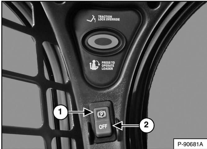
Oprima el extremo superior del interruptor (ítem 1) [Figura 38] para aplicar el freno de parqueo. La luz roja en el interruptor se ENCIENDE. El sistema de tracción se asegura.
