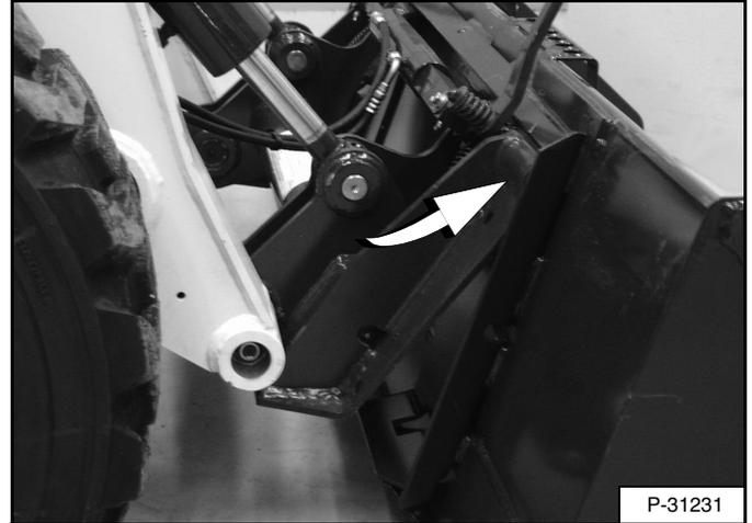
Maneje el cargador lentamente hacia adelante hasta que el borde superior del Bob-Tach quede completamente debajo de la pestaña superior del bastidor de fijación del cucharón [Figura 151] (o de otro aditamento).
