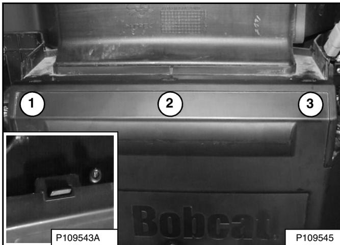
2. Empuje la cubierta hacia arriba tres lugares (ítem 1, 2 y 3) hasta que las ranuras se encajen en su lugar. Esta ranura (interior) [Figura 200] está ajustada correctamente.
