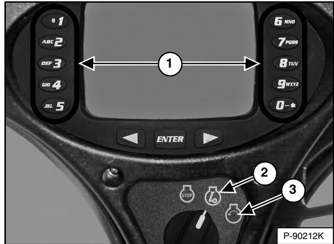
Gire el interruptor de llave a RUN (ítem 2). Las luces indicadoras en el panel de instrumentos izquierdo se ENCENDERÁN brevemente y el panel de instrumentos / sistema de monitoreo realizará una autopruueba. Use el teclado numérico (ítem 1) [Figura 131] para digitar la clave.
