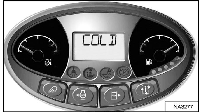
El controlador del motor no permite alcanzar la velocidad y torque máxima del motor si el motor tiene la temperatura demasiado baja. El controlador del motor realiza automáticamente las siguientes acciones:
