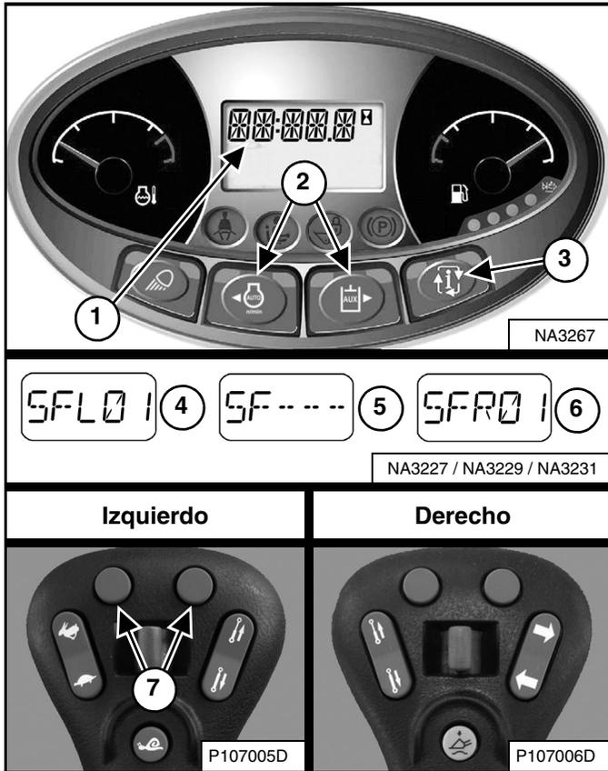
Oprima el botón de información (ítem 3) para activar la pantalla de datos hasta que aparezca el menú de la compensación de deriva de la dirección. El ajuste actual de la compensación aparece en la pantalla de datos (ítem 1) [Figura 75].
