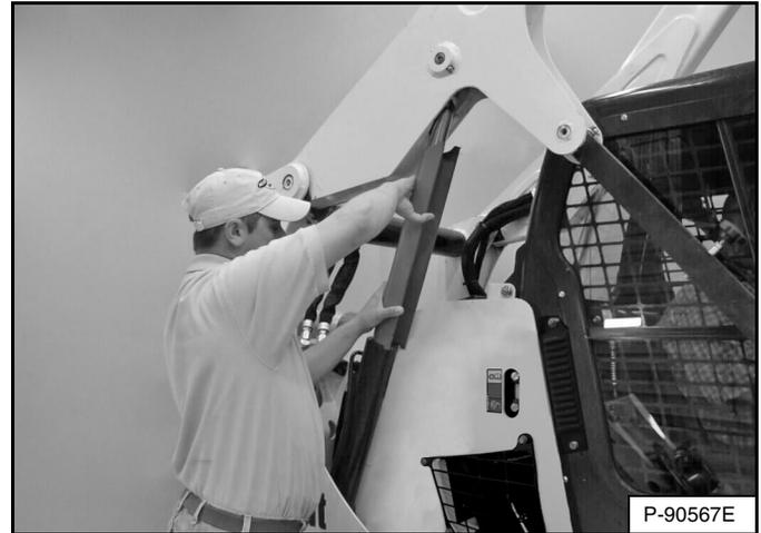
Una segunda persona debe instalar el dispositivo de soporte del brazo de elevación sobre la biela de uno de los cilindros de elevación [Figura 173].
