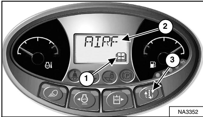
Reemplace los filtros de aire solo cuando sea necesario. El indicador de servicio (ítem 1) DESTELLA. Oprima el botón de información (ítem 3) hasta que la pantalla muestre los códigos de diagnóstico. Los códigos [AIRF] (reemplace el filtro de aire del motor) o [M0117] (filtro de aire tupido) aparecen en la pantalla (ítem 2) [Figura 202] cuando el filtro de aire se debe cambiar.
