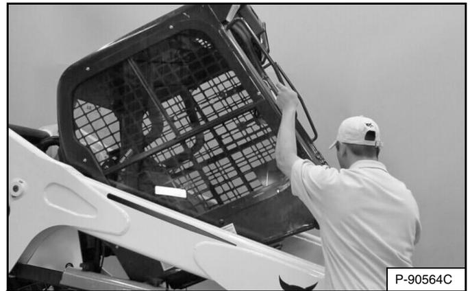
Suba las palancas de agarre y el extremo inferior de la cabina del operador [Figura 185] lentamente hasta que la cabina quede completamente arriba y el mecanismo de seguridad se enganche.
