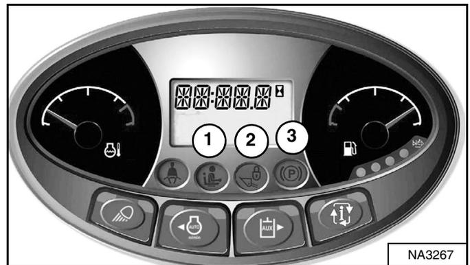
Hay tres lámparas (ítem 1, 2 y 3) [Figura 36] ubicadas en el panel de instrumentos izquierdo que deben estar APAGADAS para operar la máquina plenamente.
