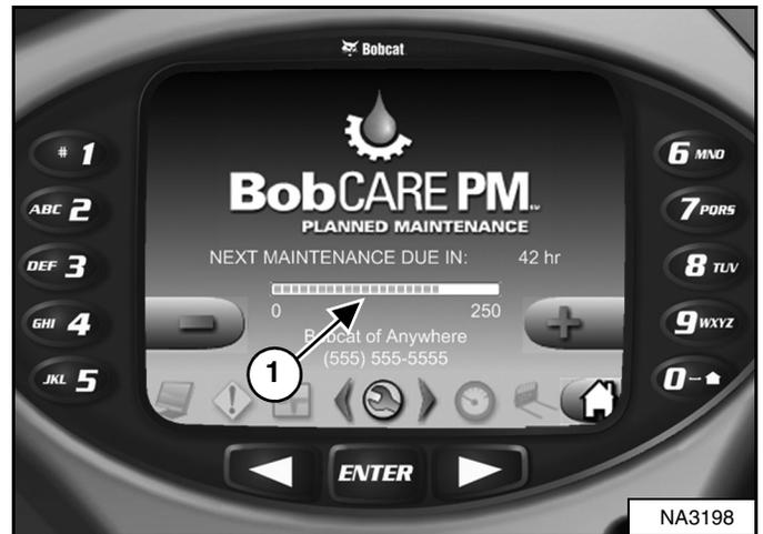
El panel de instrumentos de lujo (si está equipado) muestra una barra (ítem 1) [Figura 295] que muestra el tiempo restante para el siguiente servicio. Esta barra se vuelve roja cuando el servicio ya se debió haber hecho. La frase [NEXT MAINTENANCE DUE] (siguiente mantenimiento pendiente) se convierte en [MAINTENANCE PAST DUE] (mantenimiento en mora) y aparece el número de horas en mora.
