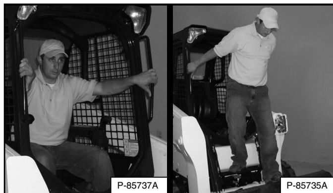
Salga del cargador usando las palancas de agarre, los peldaños de seguridad y las escalas (mantenga un contacto de tres puntos) [Figura 140].
