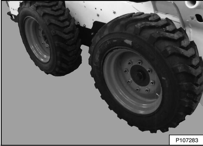
Use los torques específicos a continuación en las tuercas de las ruedas [Figura 254]:
