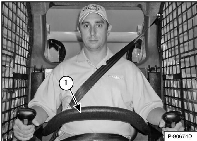
El Sistema de Enclavamiento de Controles Bobcat (BICS<sup>MR</sup>) tiene una barra del asiento que hace pivote con descansa brazos (ítem 1) [Figura 35]. El operador controla el uso de la barra del asiento.
