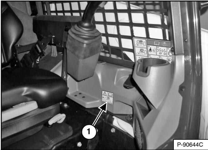
Inspeccione que la calcomanía de la alarma de alerta de retroceso no esté dañada o falte (ítem 1) [Figura 177]. Repóngala, si es del caso.
