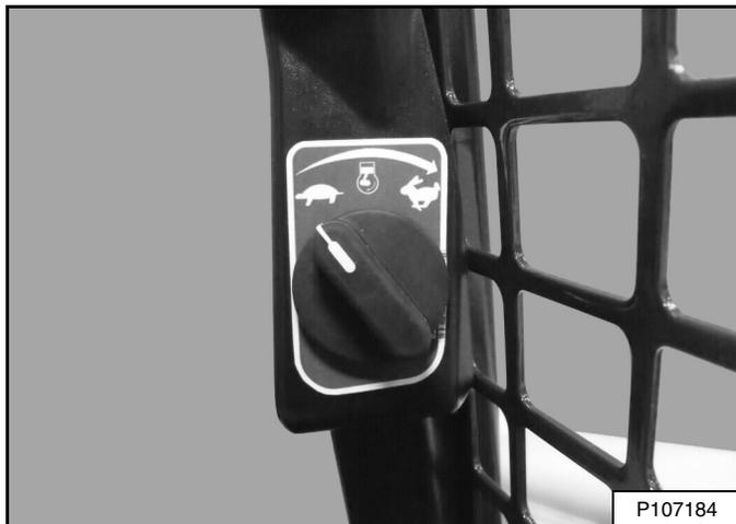
Coloque el control del motor en la posición de velocidad en ralentí baja (vacío) [Figura 138].
