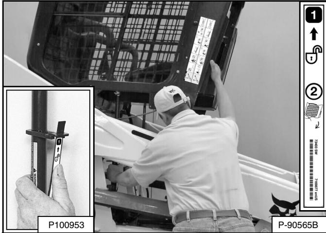
Tire hacia abajo el extremo inferior de la cabina del operador hasta que ésta se detenga en el mecanismo de seguridad [Figura 186].
