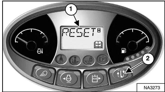
Oprima el botón de información (ítem 2) [Figura 296] hasta que la pantalla muestre el reloj de mantenimiento.
