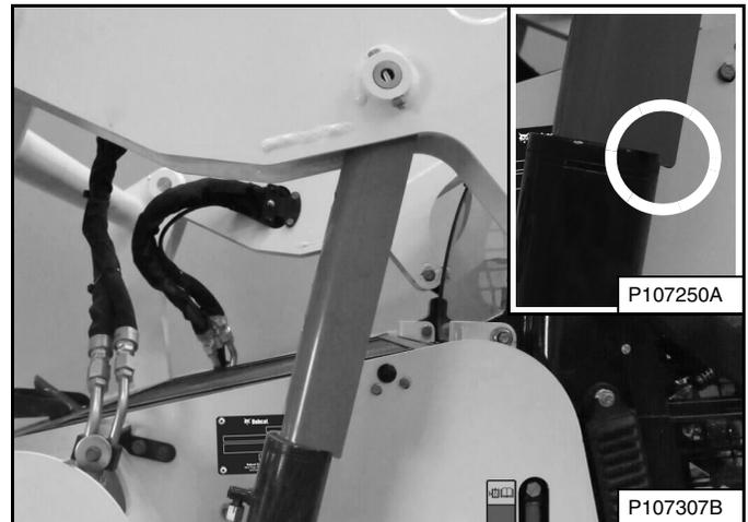
Baje los brazos de elevación lentamente hasta que el dispositivo de soporte quede sostenido entre los brazos y el cilindro de elevación. Las lengüetas del dispositivo de soporte del brazo deben atravesar la punta del cilindro (interior) [Figura 174].
