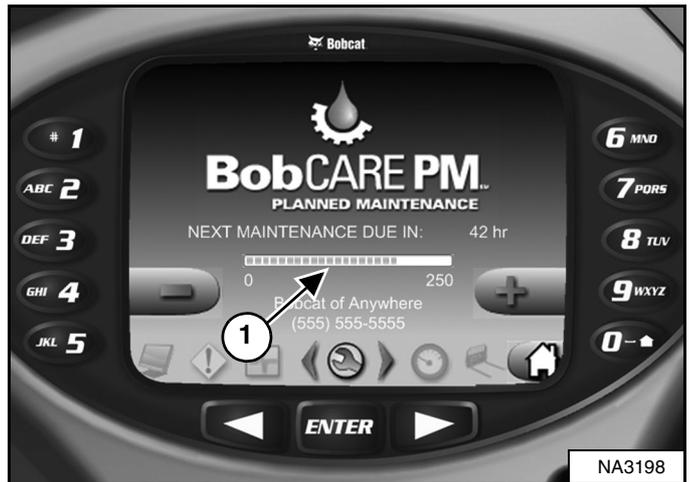
El panel de instrumentos de lujo (si está equipado) muestra una barra (ítem 1) [Figura 291] que muestra el tiempo restante para el siguiente servicio. Esta barra se vuelve roja cuando el servicio ya se debió haber hecho. La frase [NEXT MAINTENANCE DUE] (siguiente mantenimiento pendiente) se convierte en [MAINTENANCE PAST DUE] (mantenimiento en mora) y aparece el número de horas en mora.
