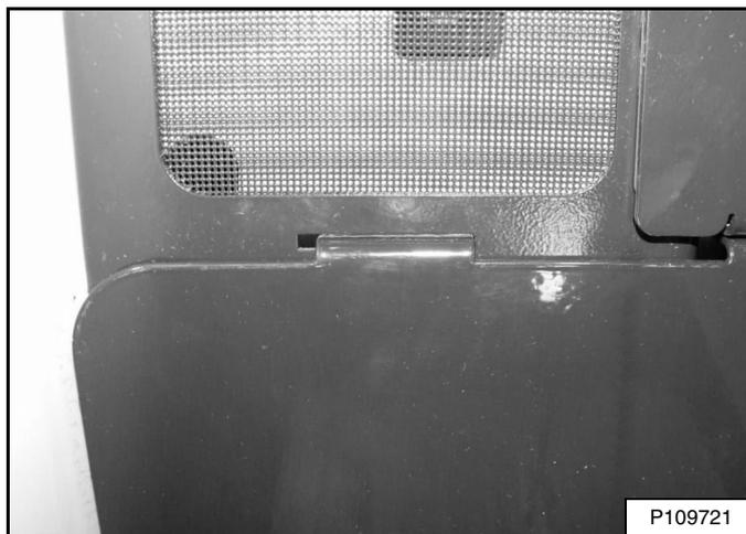
Inserte las lengüetas de la rejilla dentro de las ranuras en las dos cubiertas laterales [Figura 193]. (Se muestra el lado izquierdo).
