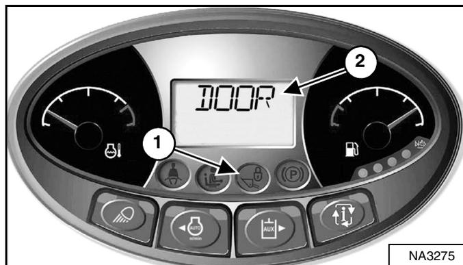
La lámpara de la VÁLVULA DE ELEVACIÓN E INCLINACIÓN (ítem 1) [Figura 179] se APAGA cuando la puerta se cierra, el interruptor de llave se coloca en RUN, la barra del asiento de baja y el botón PRESS TO OPERATE LOADER se oprime.
