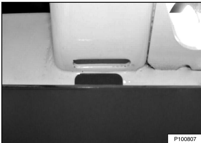
Inserte la lengüeta delantera de las dos cubiertas laterales con las ranuras del bastidor del cargador y bájelas [Figura 190]. (Se muestra el lado derecho).
