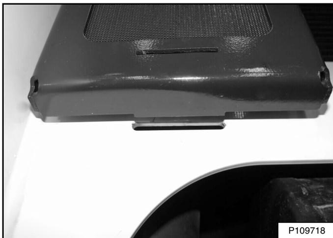
Inserte la lengüeta trasera de las dos cubiertas laterales con las ranuras del bastidor del cargador y bájelas [Figura 191]. (Se muestra el lado izquierdo).
