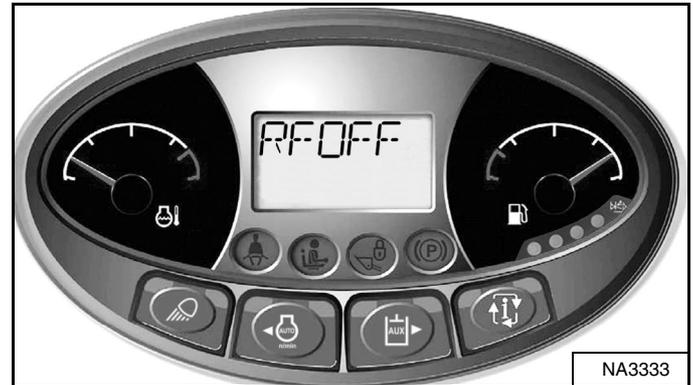
El ventilador inverso se deshabilita cuando el refrigerante o fluido hidráulico del motor tiene una temperatura demasiado alta o demasiado baja.
