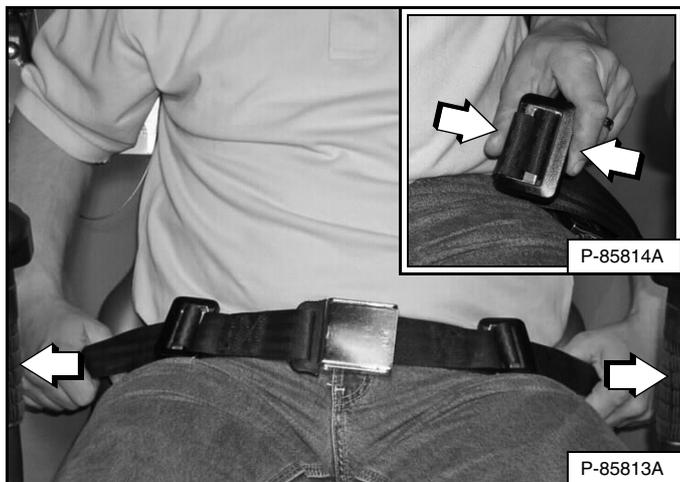
Apriete ambos ajustadores para soltar y alargar cada mitad del cinturón de seguridad (interior) [Figura 113].
