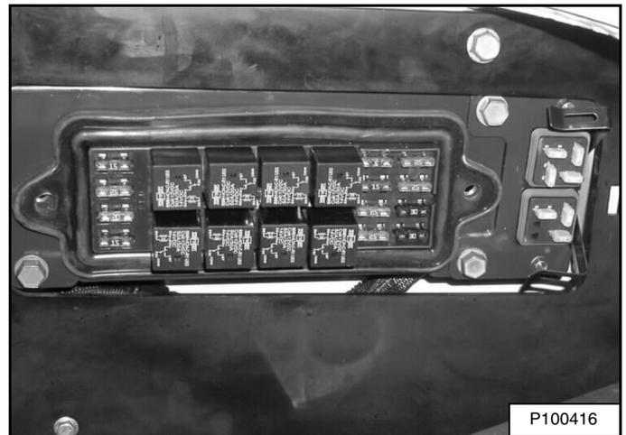
Quite las cubiertas para revisar o cambiar los fusibles [Figura 229].
