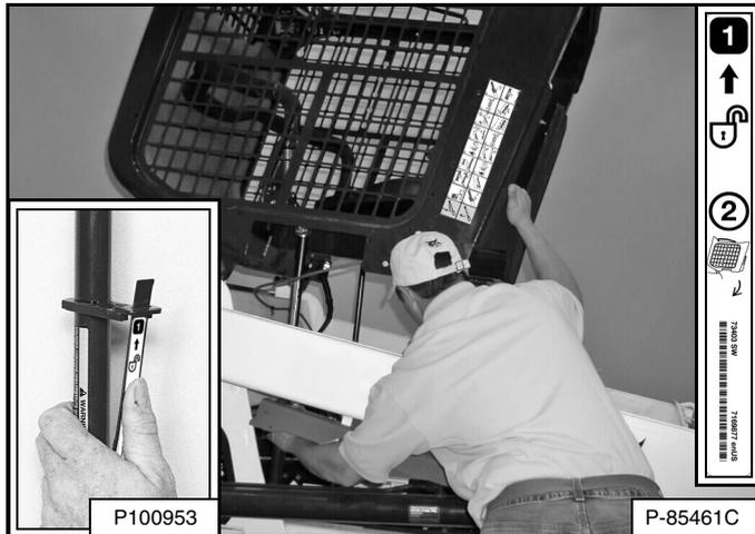
Tire hacia abajo el extremo inferior de la cabina del operador hasta que ésta se detenga en el mecanismo de seguridad [Figura 183].
