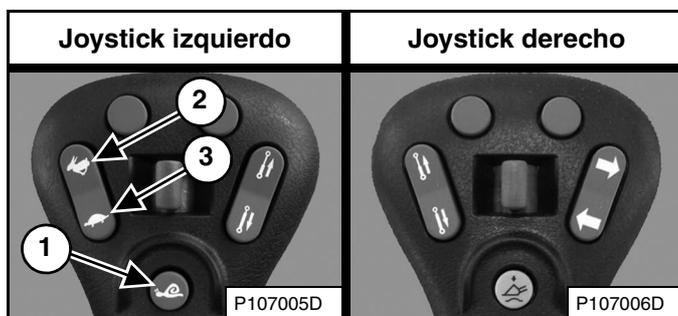
Ajuste un porcentaje de velocidad mayor (ítem 2) o menor (ítem 3) [Figura 69] oprimiendo el interruptor de control de velocidad hasta que aparezca el ajuste por defecto que desea.
