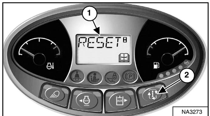
Oprima el botón de información (ítem 2) [Figura 292] hasta que la pantalla muestre el reloj de mantenimiento.
