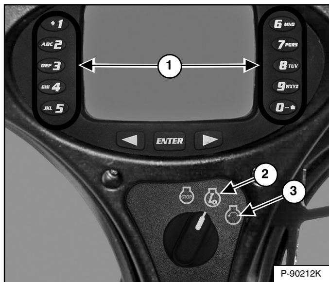
Gire el interruptor a RUN (ítem 2) [Figura 129]. Las luces indicadoras en el panel de instrumentos izquierdo se ENCENDERÁN brevemente y el panel de instrumentos / sistema de monitoreo efectuará una autoprueba.
