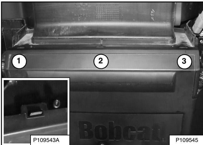
2. Empuje la cubierta hacia arriba tres lugares (ítem 1, 2 y 3) hasta que las ranuras se encajen en su lugar. Esta ranura (interior) [Figura 201] está ajustada correctamente.
