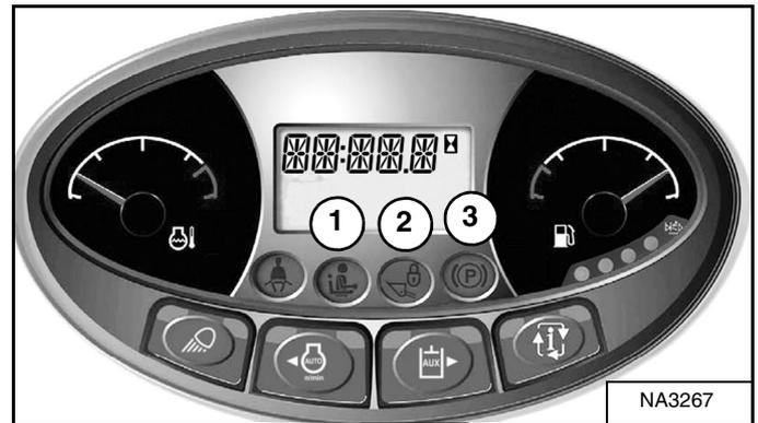
Hay tres lámparas (ítem 1, 2 y 3) [Figura 35] ubicadas en el panel de instrumentos izquierdo que deben estar APAGADAS para operar la máquina plenamente.
