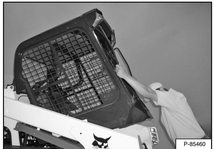
Suba las palancas de agarre y el extremo inferior de la cabina del operador [Figura 182] lentamente hasta que la cabina quede completamente arriba y el mecanismo de seguridad se enganche.
