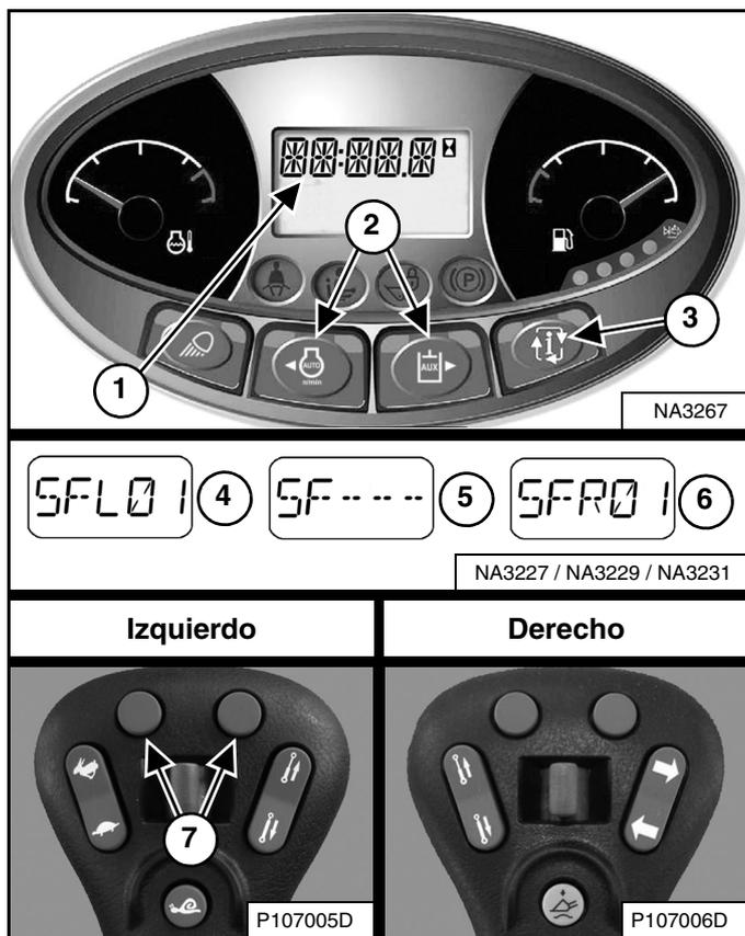
Oprima el botón de información (ítem 3) para activar la pantalla de datos hasta que aparezca el menú de la compensación de deriva de la dirección. El ajuste actual de la compensación aparece en la pantalla de datos (ítem 1) [Figura 73].
