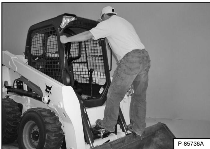
Use los escalas del cucharón o aditamento, las palancas de agarre y los peldaños de seguridad (en el brazo y el bastidor del cargador) para ingresar y salir del cargador, manteniendo 3 puntos de contacto todo el tiempo [Figura 104]. No salte.
