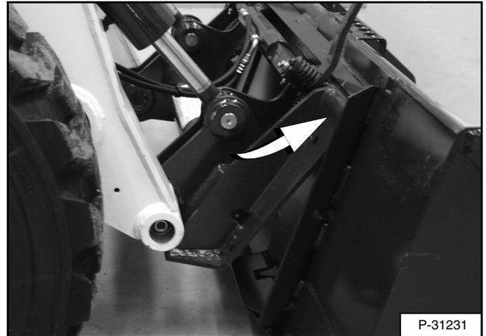
Maneje el cargador lentamente hacia adelante hasta que el borde superior del bastidor del Bob-Tach quede completamente debajo de la pestaña superior del bastidor de fijación del cucharón [Figura 147] (o de otro aditamento).
