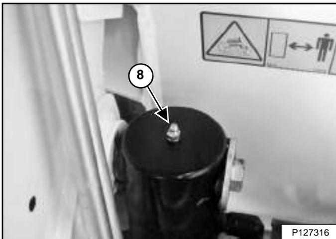
8. Punta de la base del cilindro de inclinación (ambos lados) (2) [Figura 156].
