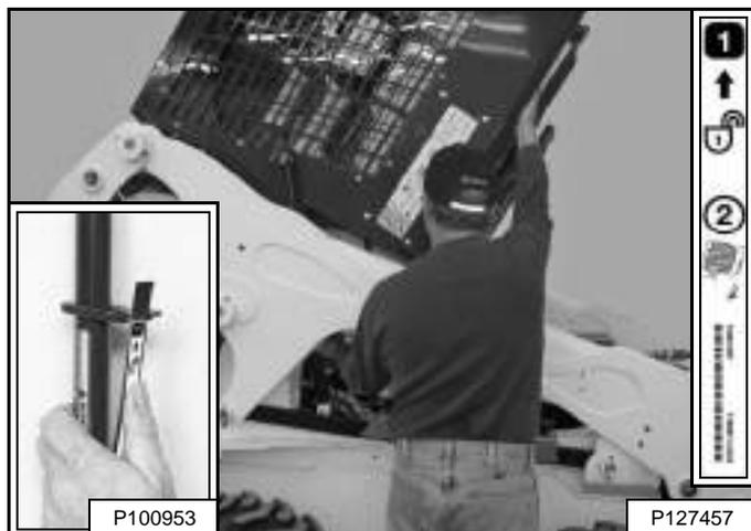
Tire hacia abajo el extremo inferior de la cabina del operador hasta que ésta se detenga en el mecanismo de seguridad [Figura 90].
