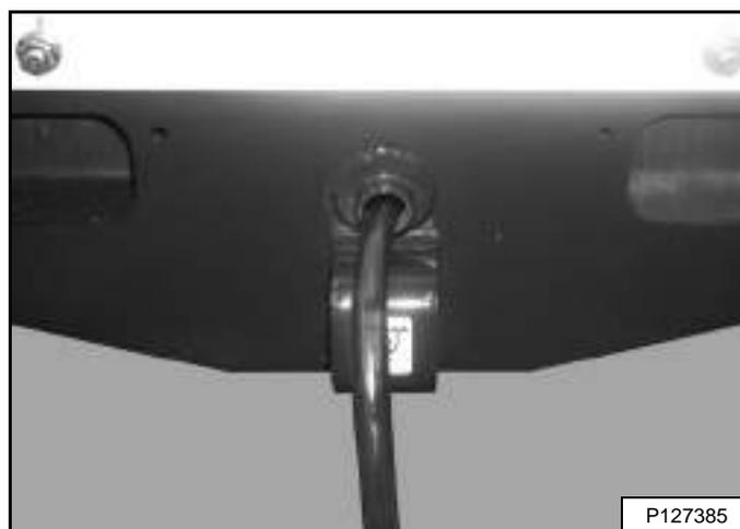
Bombee el fluido retirándolo de la caja de la cadena [Figura 143]. (Los brazos de elevación se muestran levantados para describir el procedimiento con claridad)
