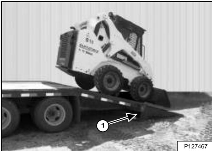
Un cargador con un cucharón vacío o sin aditamento debe cargarse en retroceso sobre el vehículo de transporte [Figura 68].
