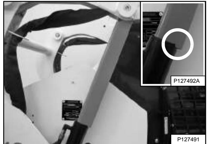
Baje los brazos de elevación lentamente hasta que el dispositivo de soporte quede sostenido entre los brazos y el cilindro de elevación. Las lengüetas del dispositivo de soporte del brazo deben atravesar la punta del cilindro (interior) [Figura 80].
