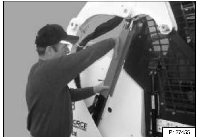
Una segunda persona debe instalar el dispositivo de soporte del brazo de elevación sobre la biela de uno de los cilindros de elevación [Figura 79].
