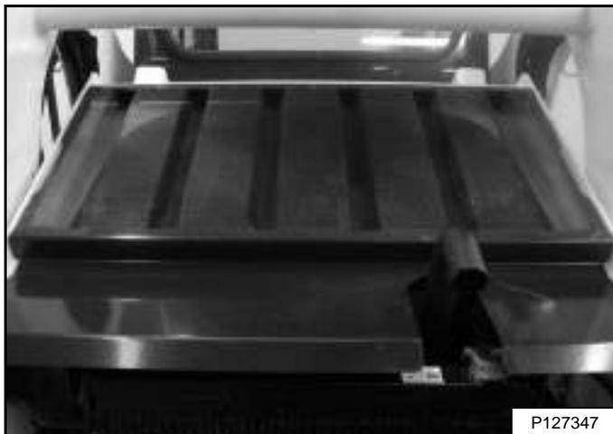
Levante y tire de la rejilla trasera para retirarla del cargador **[Figura 95]**.
