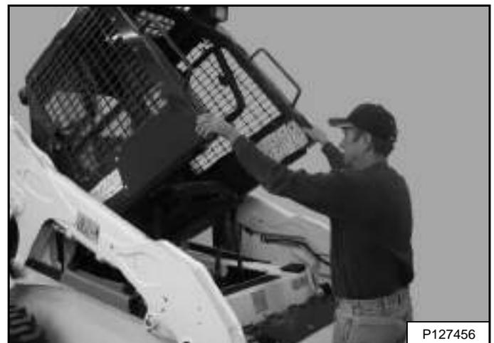
Suba las palancas de agarre y el extremo inferior de la cabina del operador [Figura 89] lentamente hasta que la cabina quede completamente arriba y el mecanismo de seguridad se enganche.
