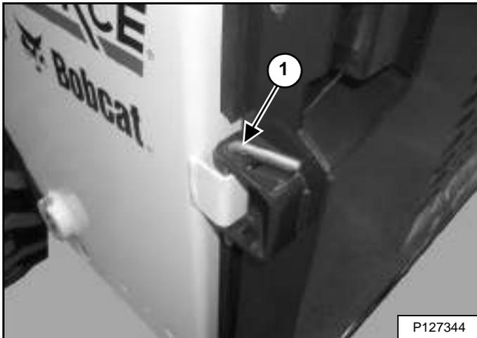
Retire el pasador de seguridad (ítem 1) [Figura 92] y tire de la compuerta trasera para abrirla.
