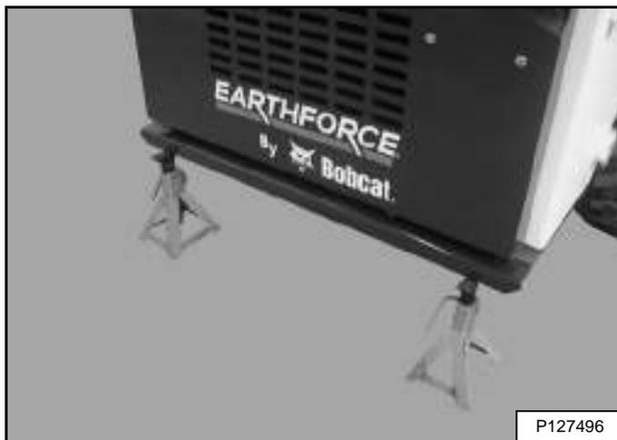
Instale los soportes debajo del extremo posterior del bastidor del cargador [Figura 87].
