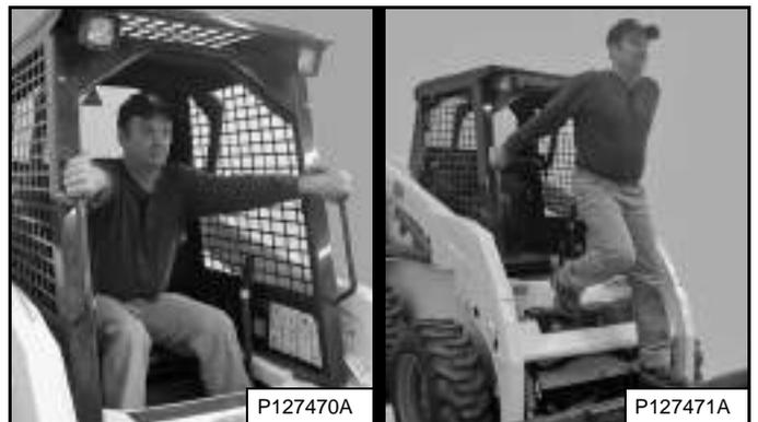
Salga del cargador usando las palancas de agarre, los peldaños de seguridad y los escalas (mantenga un contacto de tres puntos) [Figura 53].
