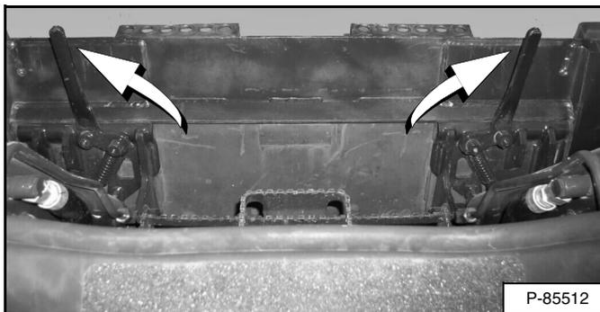
Tire de las palancas del Bob-Tach (enganche manual) hacia arriba [Figura 140] hasta que queden completamente levantadas (cuñas completamente levantadas).
