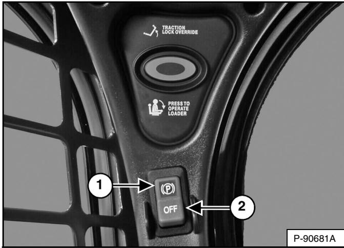
Oprima el extremo superior del interruptor (ítem 1) [Figura 37] para aplicar el freno de parqueo. La luz roja en el interruptor se ENCIENDE. El sistema de tracción se asegura.
