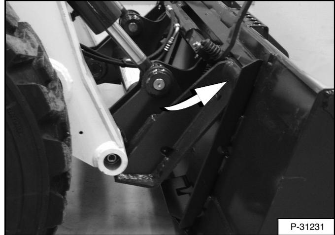
Maneje el cargador lentamente hacia adelante hasta que el borde superior del Bob-Tach quede completamente debajo de la pestaña superior del bastidor de fijación del cucharón [Figura 144] (o de otro aditamento).
