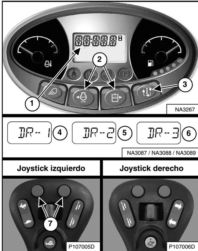
Oprima el botón de información (ítem 3) para activar la pantalla de datos hasta que aparezca el menú de la sensibilidad de transmisión. La configuración actual aparece en la pantalla de datos (ítem 1) [Figura 71].
