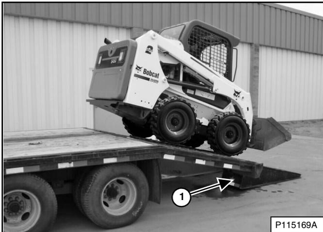
Un cargador con un cucharón vacío o sin aditamento debe cargarse en reversa sobre el vehículo de transporte [Figura 158].
