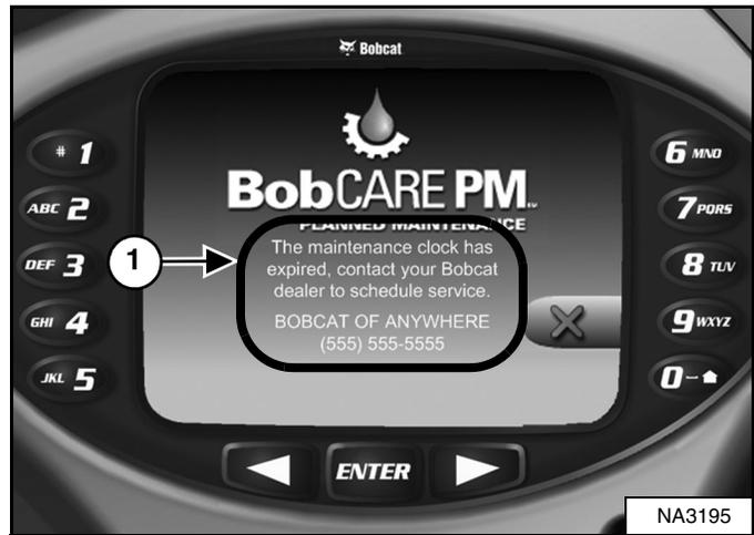
El panel de instrumentos de lujo (si está equipado) muestra un mensaje (ítem 1) [Figura 287] que alerta al operador dar servicio a la máquina.
