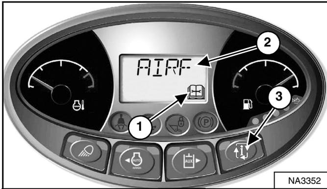
Reemplace los filtros de aire solo cuando sea necesario. El indicador de servicio (ítem 1) DESTELLA. Oprima el botón de información (ítem 3) hasta que la pantalla muestre los códigos de diagnóstico. Los códigos **[AIRF]** (reemplace el filtro de aire del motor) o **[M0117]** (filtro de aire tupido) aparecen en la pantalla (ítem 2) **[Figura 196]** cuando el filtro de aire se debe cambiar.
