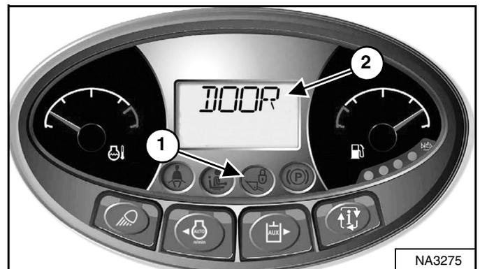
La lámpara de la VÁLVULA DE ELEVACIÓN E INCLINACIÓN (ítem 1) [Figura 176] se APAGA cuando la puerta se cierra, el interruptor de llave se coloca en RUN, la barra del asiento de baja y el botón PRESS TO OPERATE LOADER se oprime.
