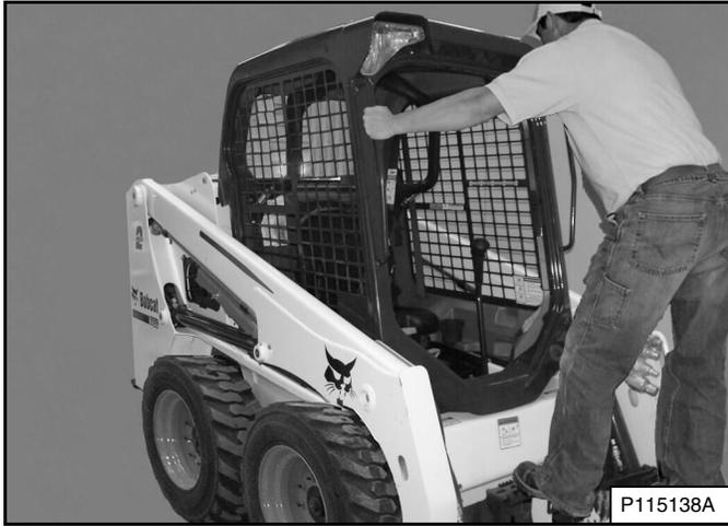
Use los escalas del cucharón o aditamento, las palancas de agarre y los peldaños de seguridad (en el brazo y el bastidor del cargador) para ingresar y salir del cargador, manteniendo 3 puntos de contacto todo el tiempo [Figura 103]. No salte.
