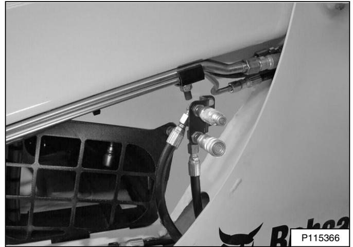
Mueva el interruptor de los hidráulicos auxiliares traseros (ítem 1) [Figura 91] o [Figura 92] hacia la derecha o izquierda para cambiar la dirección del caudal del fluido hidráulico auxiliar hacia los acoples rápidos traseros [Figura 93]. (Se muestra el lado izquierdo) (POR EJEMPLO: subir y bajar estabilizadores traseros). Suelte el interruptor para detener el caudal del fluido.
