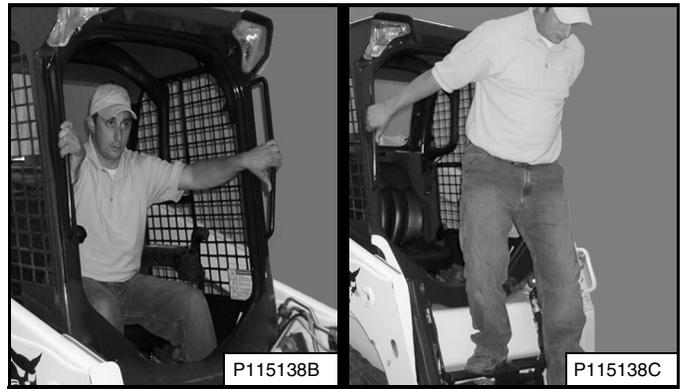
Salga del cargador usando las palancas de agarre, los peldaños de seguridad y los escalas (mantenga un contacto de tres puntos) [Figura 133].
