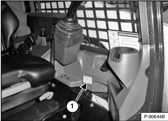
Inspeccione que la calcomanía de la alarma de alerta de reversa no esté dañada o falte (ítem 1) [Figura 171]. Repóngala, si es del caso.
