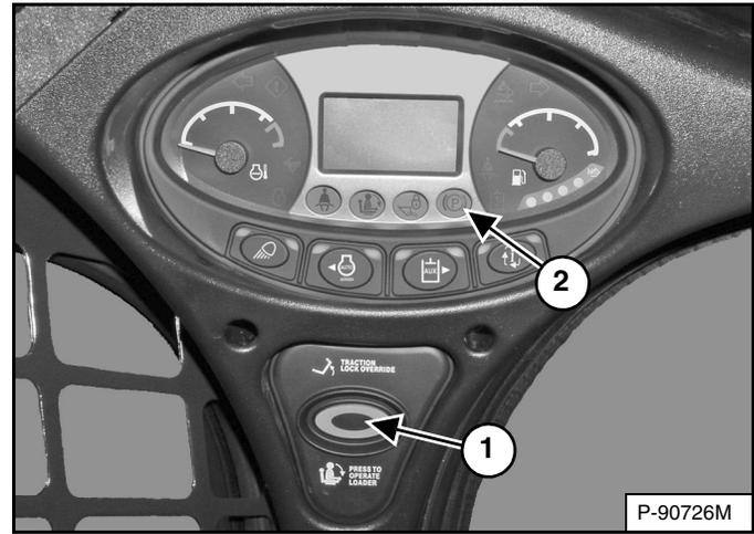
*(Solo funciona cuando la barra del asiento se sube y el motor está en marcha)* Hay un botón que ANULA EL BLOQUEO DE LA TRACCIÓN (ítem 1) [Figura 38] en el panel de instrumentos izquierdo que permite usar los controles de dirección para mover el cargador hacia adelante y atrás cuando se usa la retroexcavadora.
