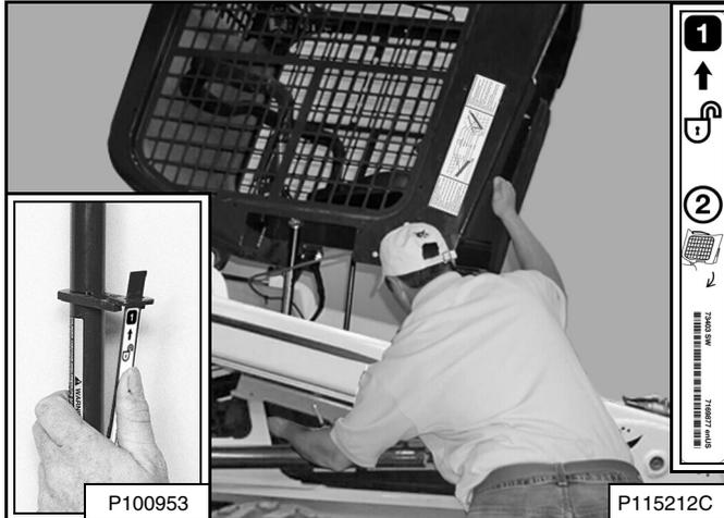
Tire hacia abajo el extremo inferior de la cabina del operador hasta que ésta se detenga en el mecanismo de seguridad [Figura 180].
