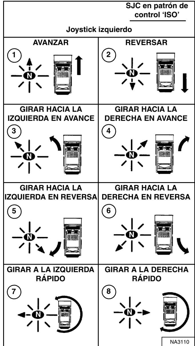
*Funciones del joystick izquierdo (manejo y dirección) [Figura 61]:*
