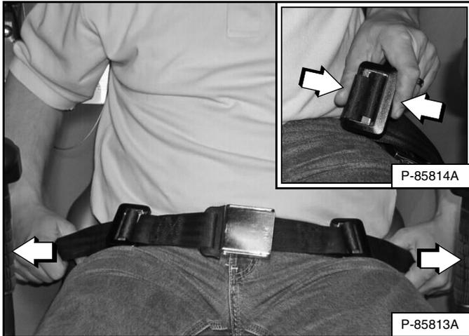
Apriete ambos ajustadores para soltar y alargar cada mitad del cinturón de seguridad (interior) [Figura 110].
