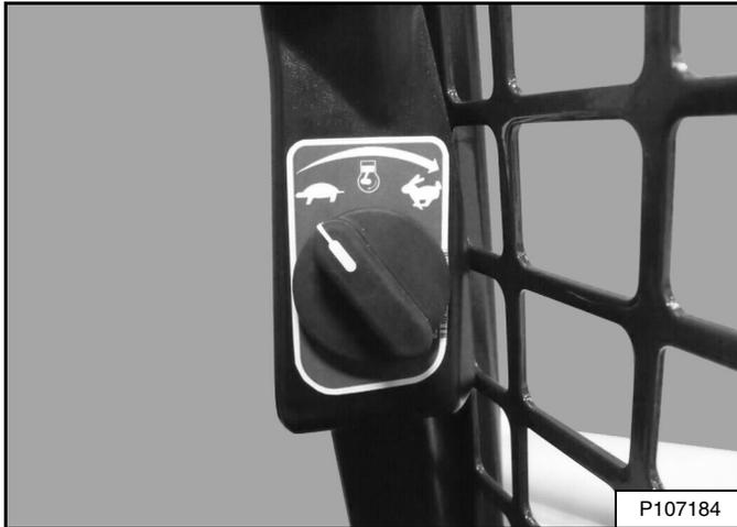
Coloque el control del motor en la posición de velocidad en ralentí baja (vacío) [Figura 115].
