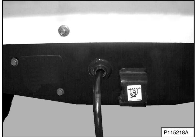
Bombee el fluido quitándolo de la caja de la cadena [Figura 253]. (Los brazos de elevación se muestran levantados para describir el procedimiento con claridad).
