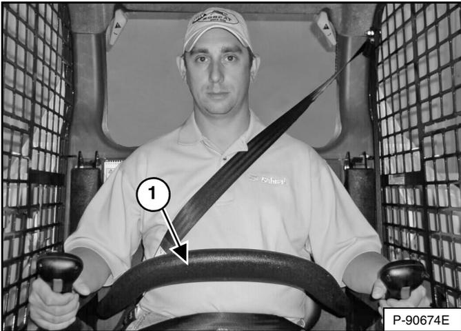
El Sistema de Enclavamiento de Controles Bobcat (BICS<sup>MR</sup>) tiene una barra del asiento que hace pivote con descansa brazos (ítem 1) [Figura 34]. El operador controla el uso de la barra del asiento.
