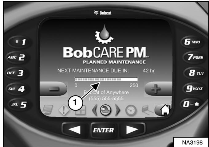
El panel de instrumentos de lujo (si está equipado) muestra una barra (ítem 1) [Figura 288] que muestra el tiempo restante para el siguiente servicio. Esta barra se vuelve roja cuando el servicio ya se debió haber hecho. La frase [NEXT MAINTENANCE DUE] (siguiente mantenimiento pendiente) se convierte en [MAINTENANCE PAST DUE] (mantenimiento en mora) y aparece el número de horas en mora.
