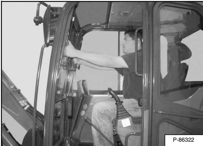
Utilice las dos palancas de agarre para halar el extremo superior de la ventana hacia adentro **[Figura 17]**.
