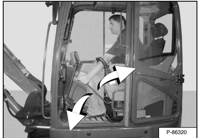
El interruptor de bloqueo de la consola desactiva las funciones de control hidráulico de las palancas de mando cuando la consola se sube [Figura 94].
