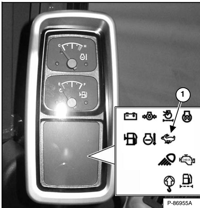
Cuando el rango alto se activa, el ícono de este control del control de desplazamiento de dos velocidades (ítem 1) [Figura 12] se ilumina.
