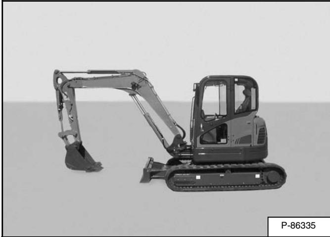
Detenga la máquina en un suelo llano. Coloque el equipo de trabajo y la pala en el suelo [Figura 73].
