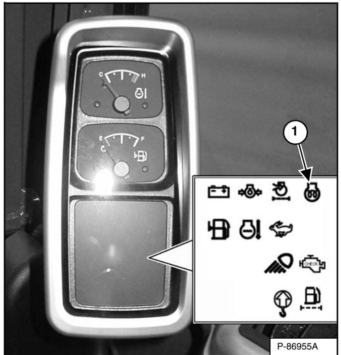
El ícono de precalentamiento (ítem 1) [Figura 72] se ENCIENDE. El calentador de aire de admisión hará ciclo automáticamente. Cuando el ícono se APAGUE, gire la llave a START.
