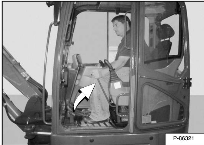
Cuando la consola izquierda se sube **[Figura 127]**, las palancas hidráulicas de control (palancas de mando y el sistema de tracción) no deben funcionar.
